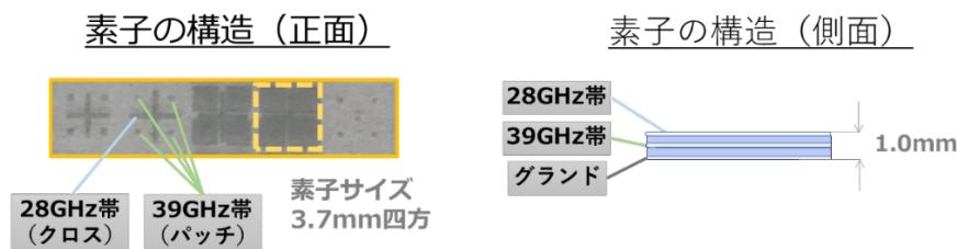
図 5-10 反射素子の構造
