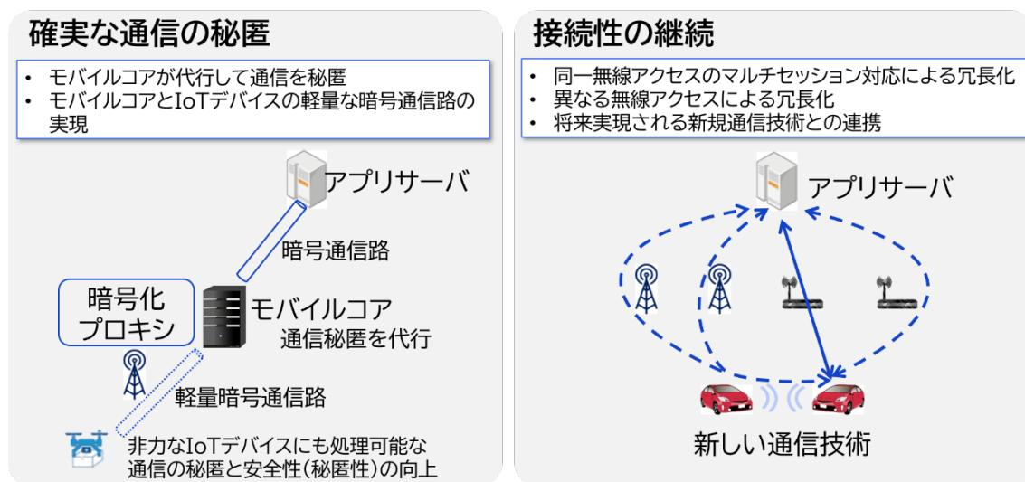
図 5-19 通信の秘匿処理の代行と、通信セッションの冗長化
