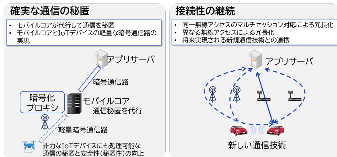
図 5-16 通信の秘匿処理の代行と、通信セッションの冗長化
