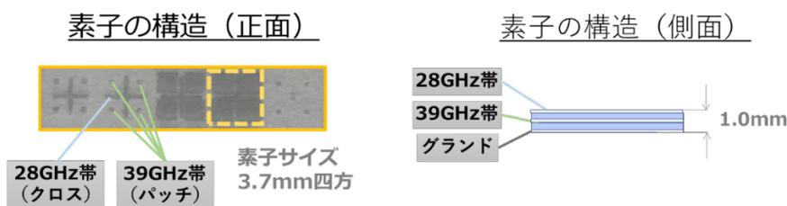
図 5-9 反射素子の構造
