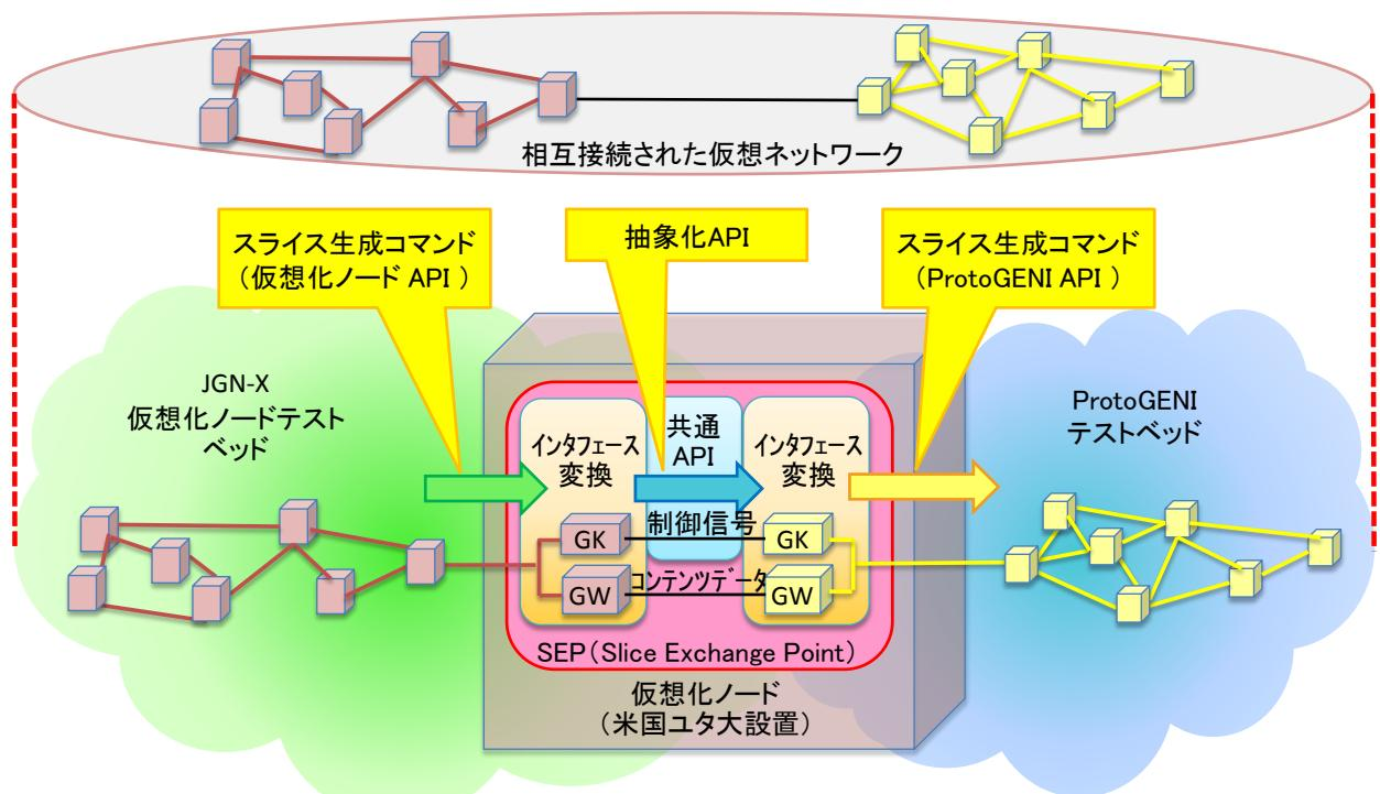
GK(GateKeeper):制御信号用インターフェース変換機能
