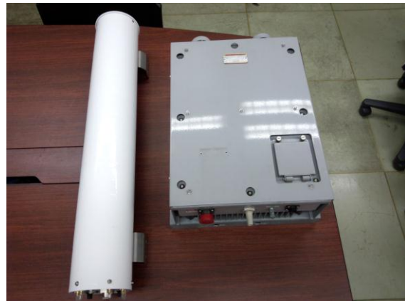
左：今回試作した無線装置内蔵アンテナ 右：従来の無線装置
